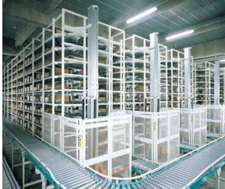
ロータリーラック H（自動入出庫タイプ） 多品種・高頻度に対応する、高速入出庫タイプの水平回転棚。
