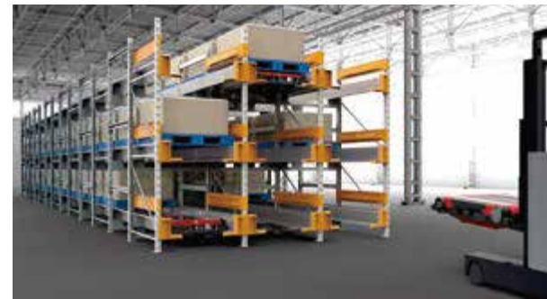
サイビスター ラック内のレーンを走行し、パレットの高密度保管、入出庫の効率化を行うパレットストレージシステム。
