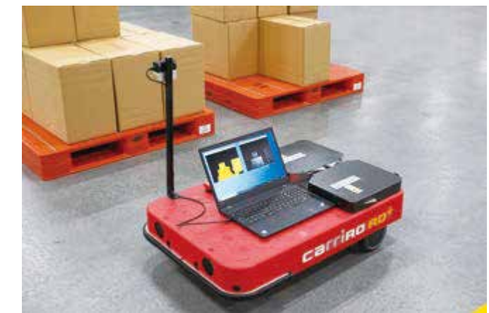
ToFカメラによる在庫管理システム
