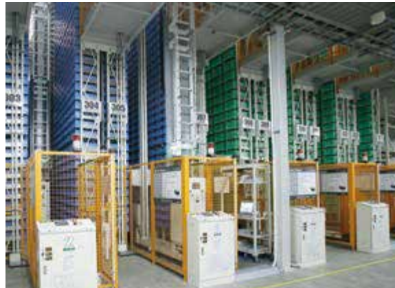
バケットスタッカー 高速スタッカークレーンを使用した、バケットタイプの立体自動倉庫。
