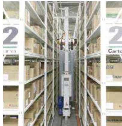
カートンスタッカー 多様なサイズのカートンケースに対応した自動倉庫。
