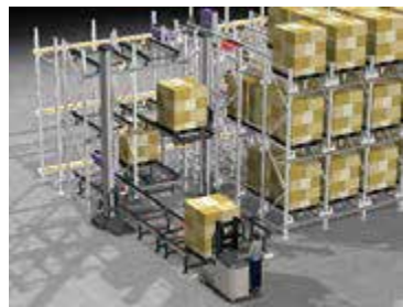
入出庫コンベヤ+垂直搬送リフター
