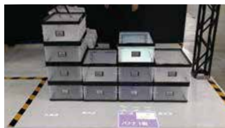
床面照射に3Dセンサを組合わせた ピッキング・仕分け作業システム
