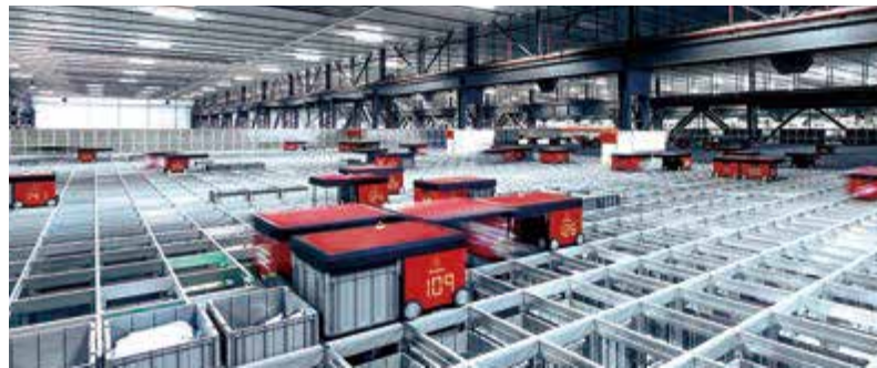
オートストア グリッド上のロボットが高密度に積み上げられたピン（コンテナ）の入出庫を行うロボットストレージシステム。
