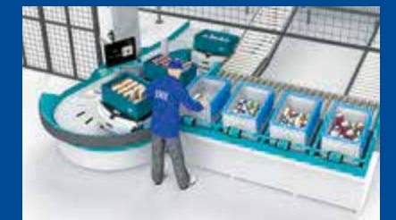
ピッカーはステーションに留まってピッキング作業に従事できる。
