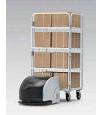
ORV （自律移動ロボット カゴ車搬送タイプ） カゴ車を自動で把持し、自らルートを生成してガイドレスで搬送。
