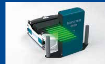
Skypodロボットは1時間に一度、自動で充電。
