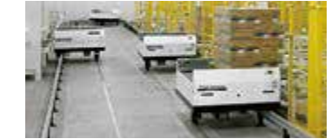
パレットトラバーサー パレットタイプの高速搬送システム。
