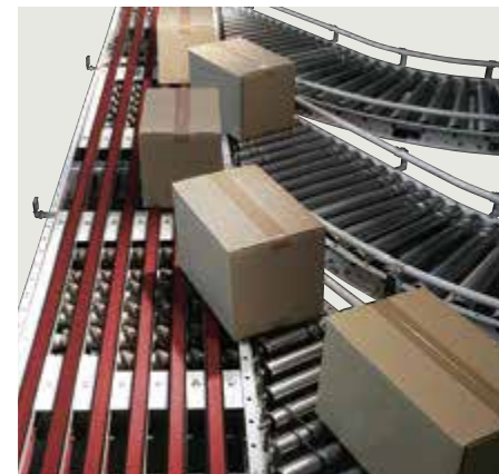
ラインベルトソーター 信頼性を追求した高品質のケース用ソーター。能力やレイアウトに合わせて3タイプを品揃え。
