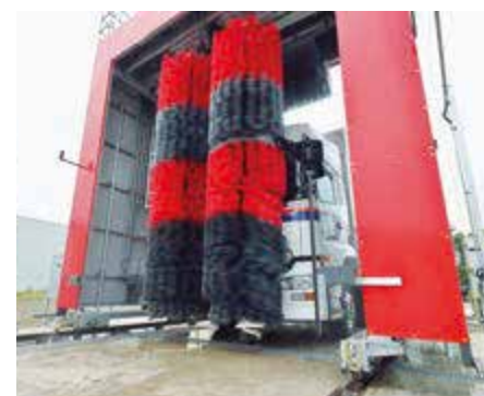
ブラシ動作の最適化などで洗車スピードを向上させた。
