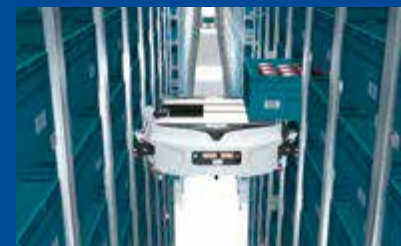
ロボット自らラックを昇降。ピンを取り出し搬送。
