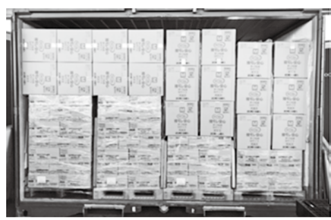
下段にサントリー製品、上段にユニ・チャーム製品 静岡県にあるサントリーの出荷拠点からの飲料(重量物)とユニ・チャームの軽量品を組み合わせた、混載輸送
