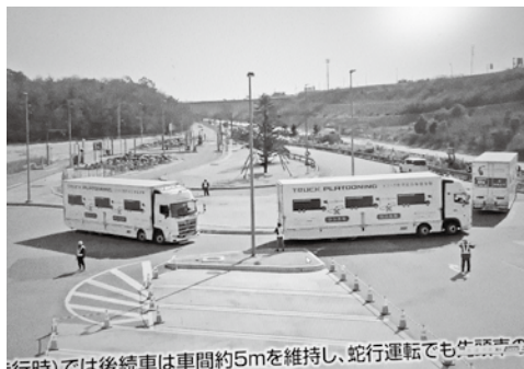
後続車は車間約5mを維持し、蛇行運転でも隊列を維持する。2月22日、福山主管支店で行われた実験風景。
